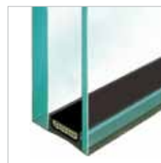
Pristillägg: Ljudglas Phon Ultra 38 WE (varm kant) Glasupbyggnad 10-16-4 mm U : 1.1 \text{ W/m}^2\text{K} R_w : 38 \text{ dB}
